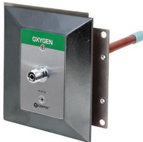
El conjunto de empalme universal debe incluir una placa de empalme (calibre 16) con tubería de entrada de gas soldada con plata a 180 grados con respecto al cuerpo de salida. La tubería de entrada será de cobre tipo "K", 1/2" D.E. (12,7 mm) y extienda 6-1/2 pulgadas (165 mm).
